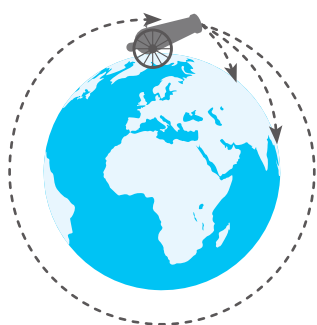
Figura 68 - Newton pensou que se a velocidade de lançamento da bala de canhão fosse suficientemente elevada, ela iria descrever uma trajetória circular, acompanhando a curvatura da Terra.
