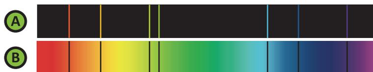
Figura 15 - Espectros de emissão do hélio (A) e espectro de absorção do mesmo elemento (B).
