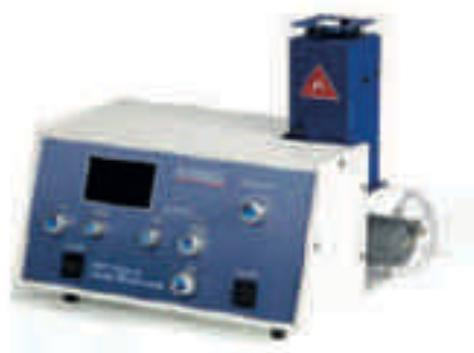
Figura 12 - Espectroscopia atómica (fotómetro de chama para análises).
