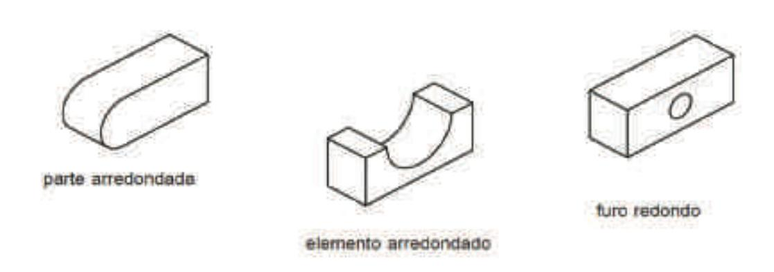
Mas antes de aprender o traçado da Perspetiva isométrica de modelos com essas características o aluno precisa de conhecer o traçado da Perspetiva isométrica do círculo. Dessa forma, não terá dificuldades em representar elementos circulares e arredondados em Perspetiva isométrica.
