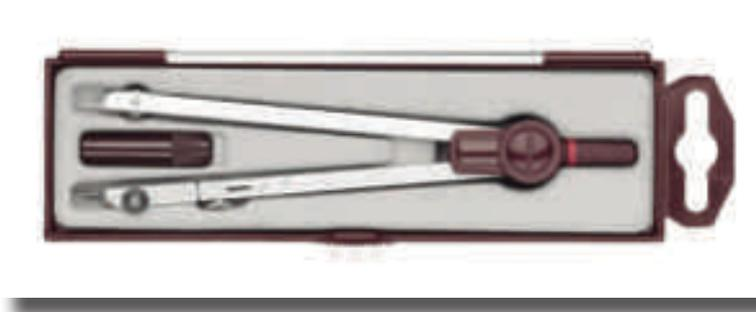
Usa-se o compasso da seguinte forma: aberto com o raio desejado, fixa-se a ponta seca no centro da circunferência a traçar e, segurando-se o compasso pela parte superior com os dedos indicador e polegar, imprime-se um movimento de rotação até completar a circunferência. Na figura 17 damos algumas instruções do uso correto deste instrumento.
