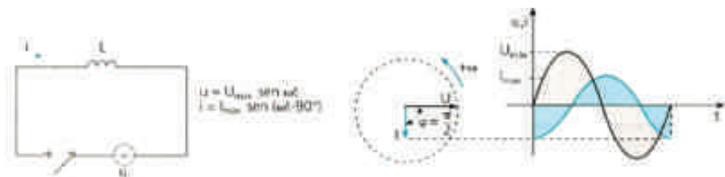
Fig. 18: Circuito puramente indutivo e representação algébrica, vetorial, cartesiana da tensão aplicada e da corrente que o percorre
