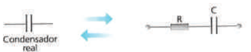
Fig. 27: Condensador real e circuito equivalente
