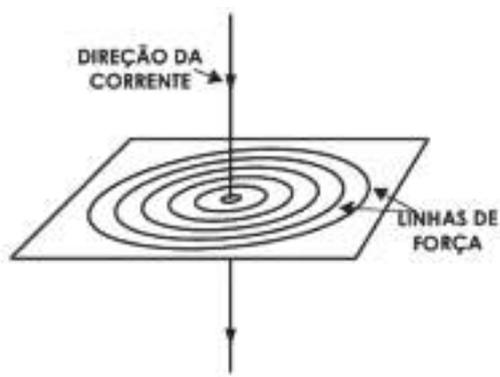
*Fig. 16: Campo magnético provocado pela corrente elétrica*
