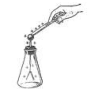
Fig. 13: Eletrização do eletroscópio por contacto
