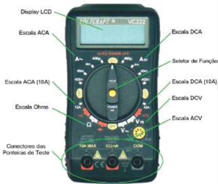
Fig.4: Foto de um multímetro VOLTcraft com auto range
