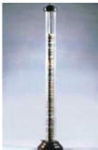
*Fig. 3: Pilha de Volta*
