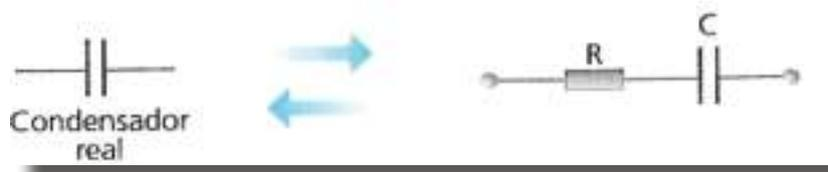
Fig. 27: Condensador real e circuito equivalente
