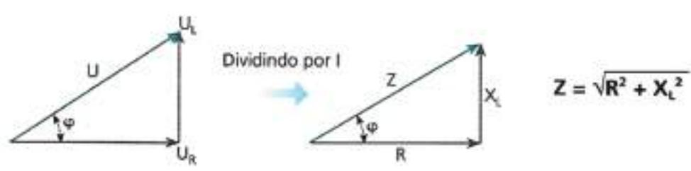
Fig. 26: Triângulo das tensões e das impedâncias
