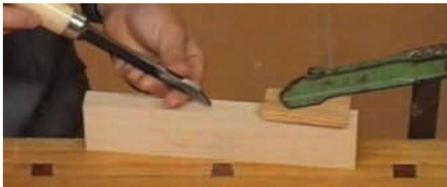
Graminha-se o segundo traço que determina a largura do furo. Regula-se o graminho pela extremidade do vínculo efetuado com o bedame, encostando sempre a guia à face da peça.
