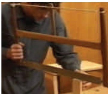
A operação de respigar inicia-se fixando a peça na prensa com a inclinação adequada, facilitando a progressão da serragem e contribuindo para uma postura ergonómica do operador.
