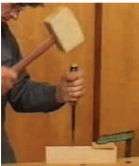
Inicia-se a furação, firmando o bedame com o gume acente entre os graminhados e com a face voltada para a traçagem que limita o comprimento do furo, garantindo uma margem de segurança em relação à traçagem.
