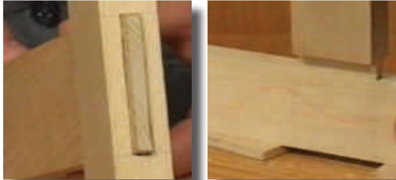
10. O engradamento e desengradamento das peças é executado por intermédio de pancadas suaves do maço com interposição de um calço para não danificar as peças.
