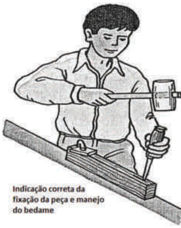
Na operação de furar, utilizam-se bedames de várias dimensões em função do furo a realizar, sendo os mais usuais os de 6mm, 8mm, 10mm e 12mm.
