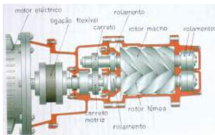
Figura 18 – Compressor de parafuso.
