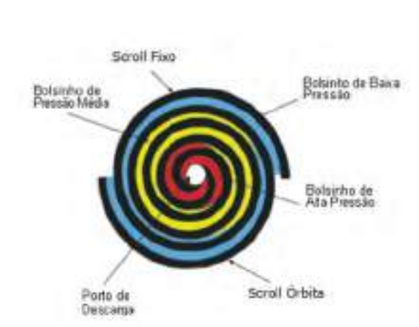
Figura 15 – Princípio de funcionamento de um compressor de espiral.
