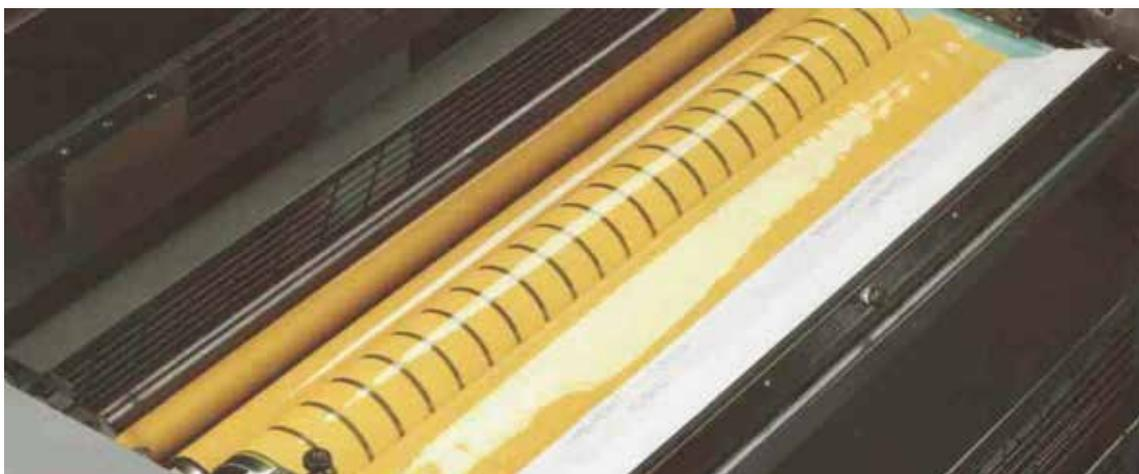
É de extrema importância que a lâmina do tinteiro e os parafusos de regulação estejam em perfeitas condições e sem incrustações de tintas secas, para que se possa manter todo o processo de impressão sem variações de carga de tinta, principalmente tratando-se de impressos que requerem maior qualidade. Nos dias de hoje, a qualidade é um fator indispensável para adquirir e manter os clientes.
