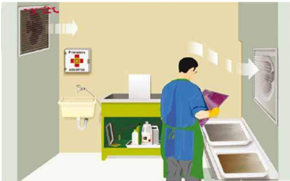
(ventilação geral da sala de revelação)
