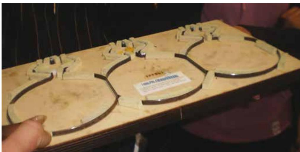
*(o cortante especial é um molde feito em base de madeira, onde as lâminas de metal desenhavam na madeira o corte que será efetuado no trabalho)*
