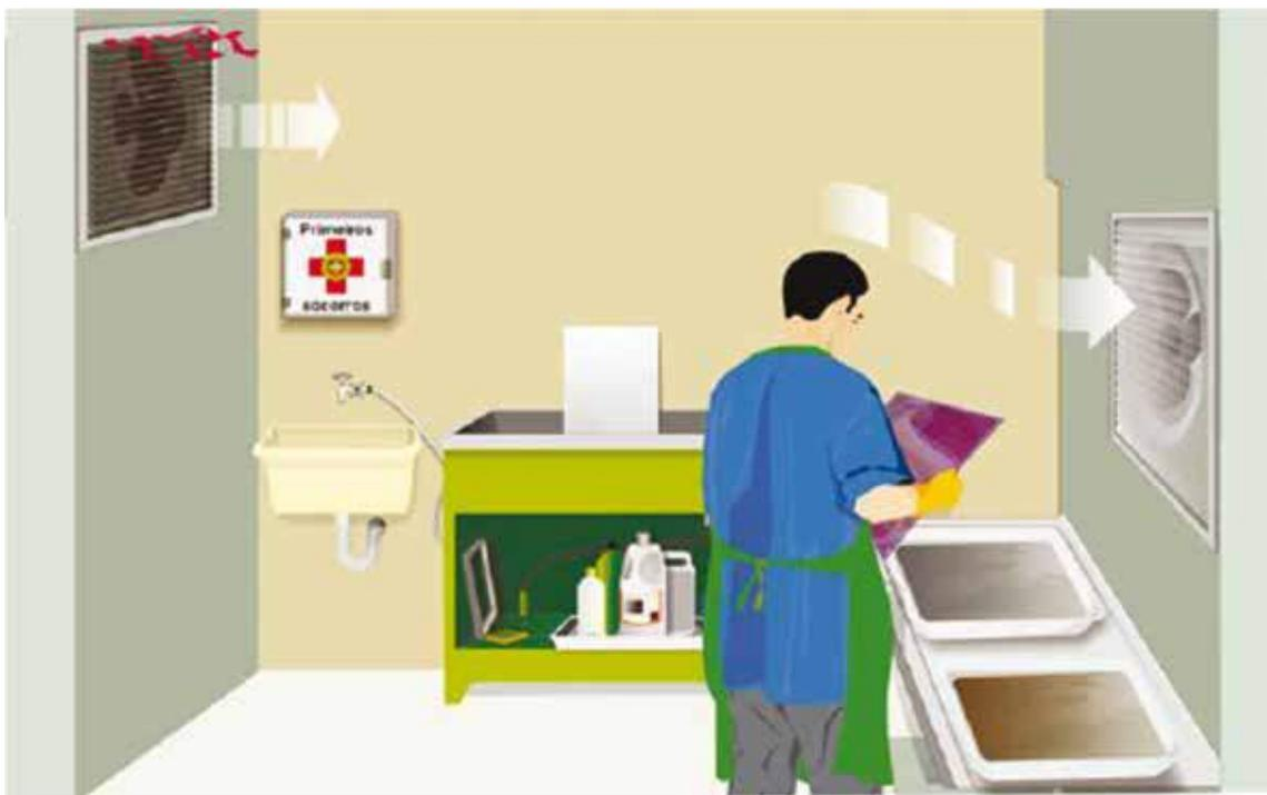
*(ventilação geral da sala de revelação)*
