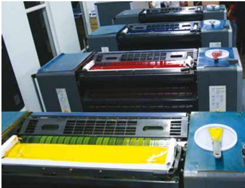
Na segunda metade dos anos noventa, o *offset* passou a contar com um aperfeiçoamento fundamental: as máquinas dotadas de sistemas CTP (*computer-to-press*), que permitem a entrada dos dados de arquivos digitais diretamente na impressora, onde é feita a gravação das chapas, dispensando fotolitos. Apesar de pouco adequado, esta modalidade tem sido designada de *offset* digital, assunto que será abordado mais à frente, em tópico separado.
