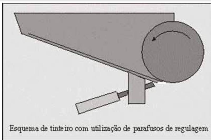
A regulação deve ser feita do centro do tinteiro para as extremidades, colocando a tira entre a lâmina e o cilindro do tinteiro (alimentador) e apertando o parafuso de regulação até sentir uma certa resistência ao tentar retirar o filme. O importante é deixar todas as faixas (zonas) por igual e depois, de acordo com a característica da imagem na chapa, “abrir ou fechar” as zonas desejadas.
