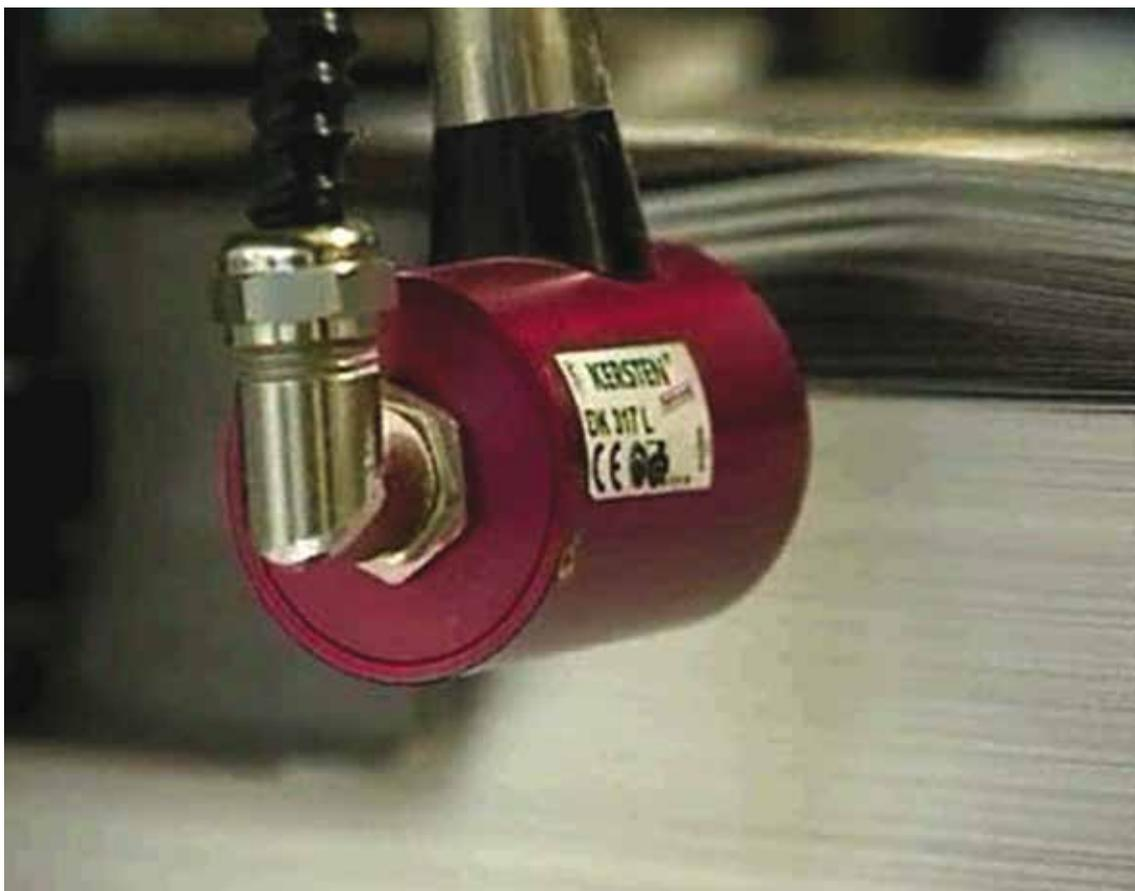
Algumas impressoras modernas possuem como opcionais sopro com ar ionizado (carregado com íons) para no momento do desfolhamento auxiliar na remoção de eletricidade estática do substrato.
