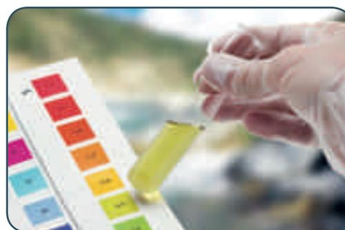
Figura 36 – Determinação de pH por colorimetria.
