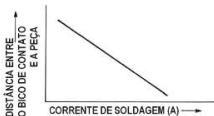
Figura 11 - Efeito da distância entre o bico de contacto e a peça na corrente de soldadura.
