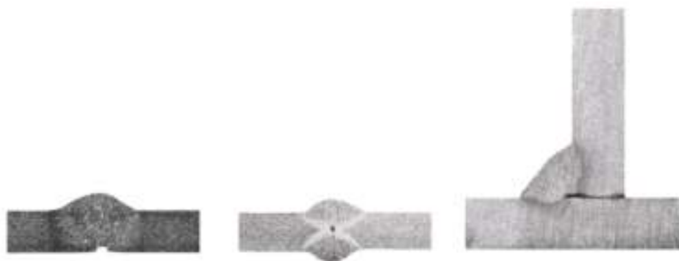
Figura 24 - Exemplos de falta de penetração.
