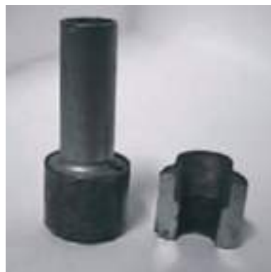
Figura 3 – Brasagem entre tubo de cobre e anel de aço.
