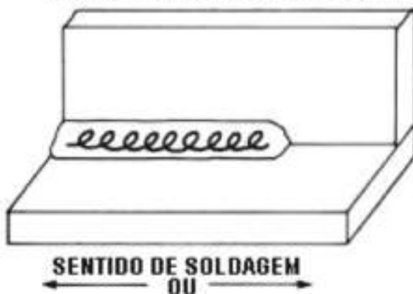
SEQUÊNCIA DE PASSES PARA UMA JUNTA EM ÂNGULO MULTIPASSE
