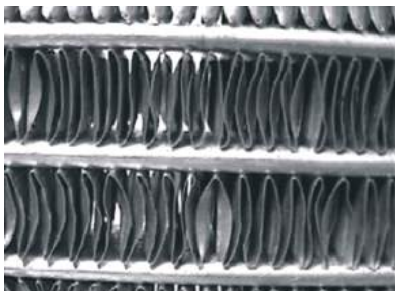
Figura 4 - Brasagem de condensadores de ar condicionado automotivo.
