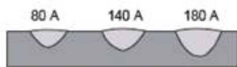
Figura 5 - Penetração de soldadura em função da corrente de soldadura.
