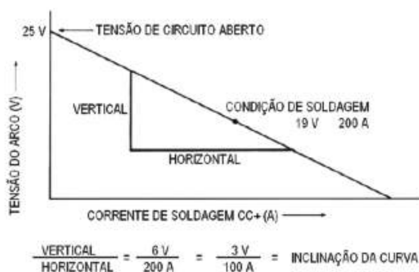
Figura 7 - Cálculo da inclinação da curva de um sistema de soldadura.
