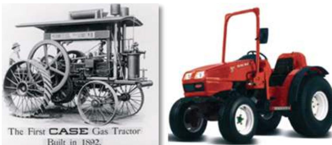
*Figura 6 - Trator a gás e trator com arco dianteiro de proteção*
