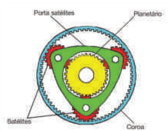
Figura 162 - Engrenagem epicicloidal
