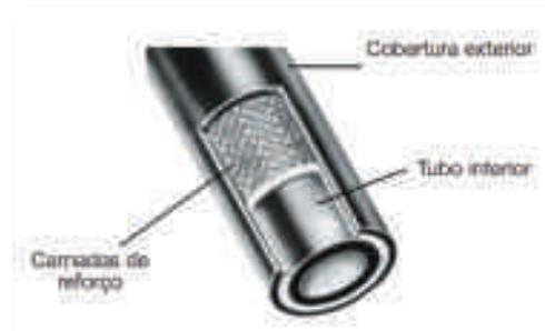
Figura 244 - Constituição de um tubo flexível
