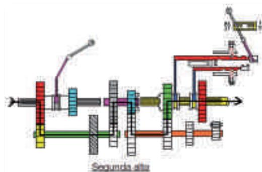
Figura 155 Caixa com 2ª Alta engrenada
