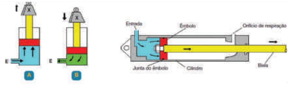
Figura 238 - Cilindros de êmbolo de simples efeito
