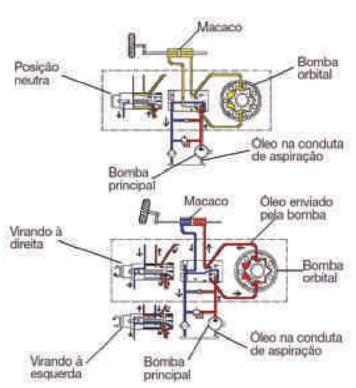
Figura 211 - Direção hidrostática
