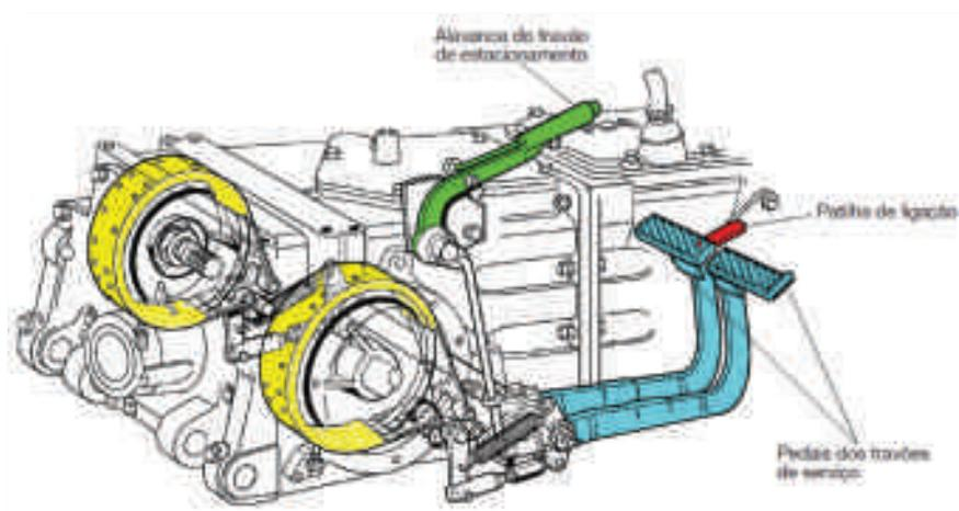
Figura 197 - Travões de serviço e de estacionamento
