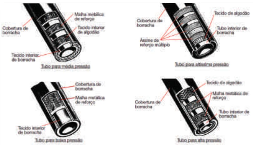
Figura 245 - Tubos flexíveis para diferentes pressões
