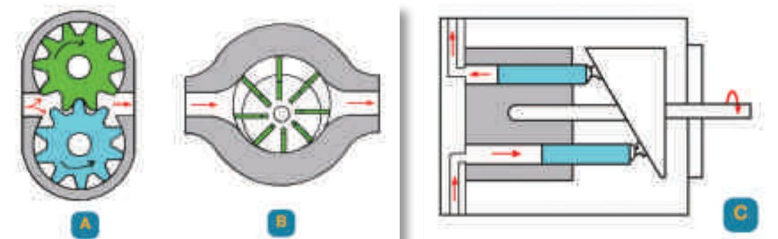
Figura 227 - Bombas hidráulicas
