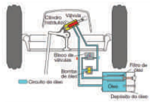
Figura 210 - Direção assistida hidráulicamente
