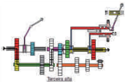
Figura 156 - Caixa com 3ª Alta engrenada
