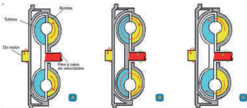
Figura 148 - Funcionamento da embraiagem hidráulica
