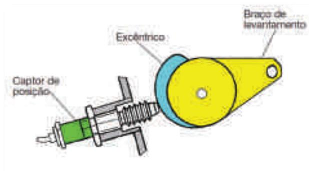
Figura 257 - Controlo de posição por comando eletrónico
