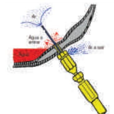
Figura 196 - Hidroinsuflador
