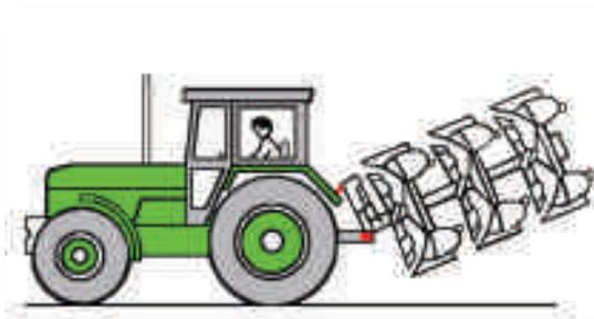
Figura 248 - Engate nos três pontos
