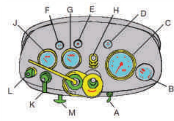
*Figura 265: A - Interruptor do motor de arranque; B - Interruptor de luzes;
