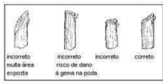
Figura 31 - Corte em bisel a 45°
